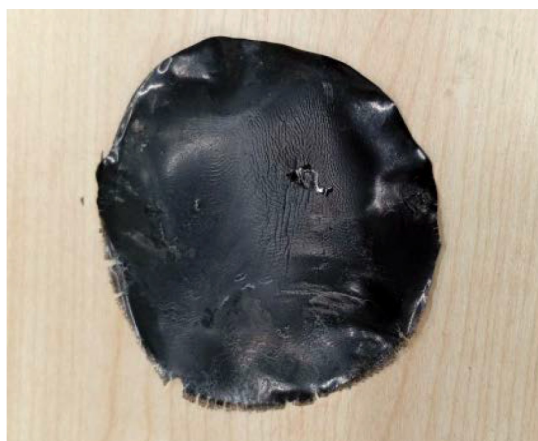
Рис. 2. Высушенный раствор черного вспененного полистирола в лимонене
