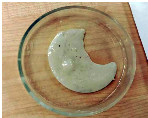
Рис. 1. Результат растворения вспененного полистирола в скипидаре
