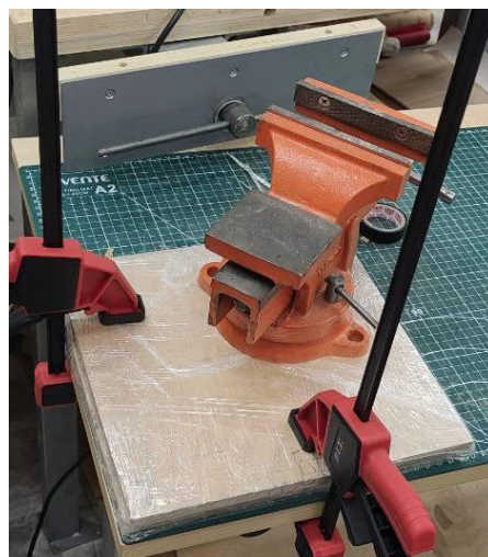
Рис. 2. Зажим пресс-формы при помощи струбцин
