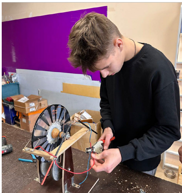
Рис. 3. Монтаж токосъемников для Лейденских банок
