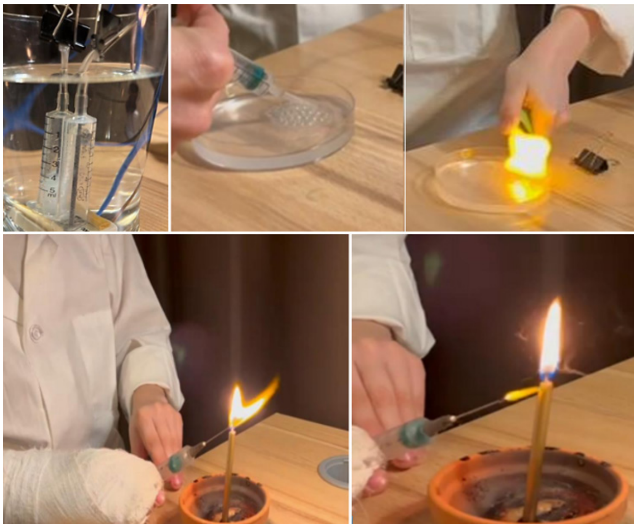
Рис. 4. Эксперимент № 5 «Электролиз воды. Горение водорода»
