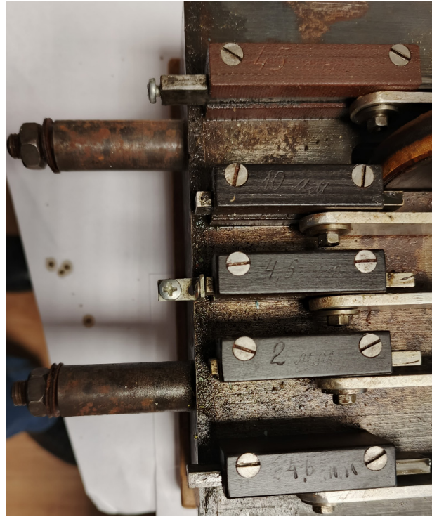
Рис. 3. Вид сверху на толкатели виброгенератора (ползуны КПМ)
