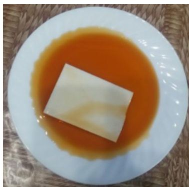
Рис. 2. Нанесение антибактериального покрытия на бумагу
