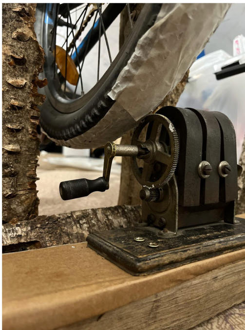
Рис. 1. Соединение колеса и динамо-машины
