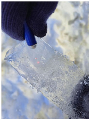
Рис. 3. Измерение толщины куска небольшой льдины
