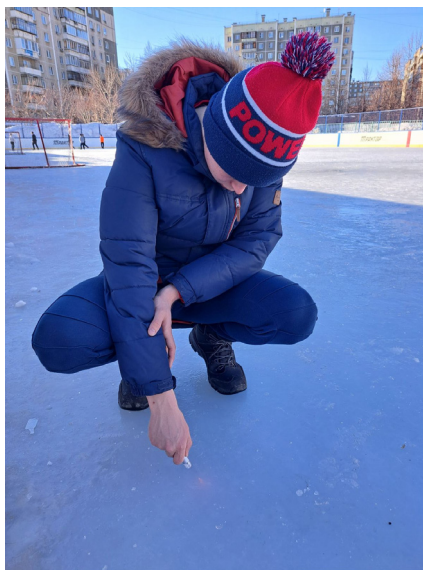
Рис. 4. Измерение толщины льда на ледовой площадке
