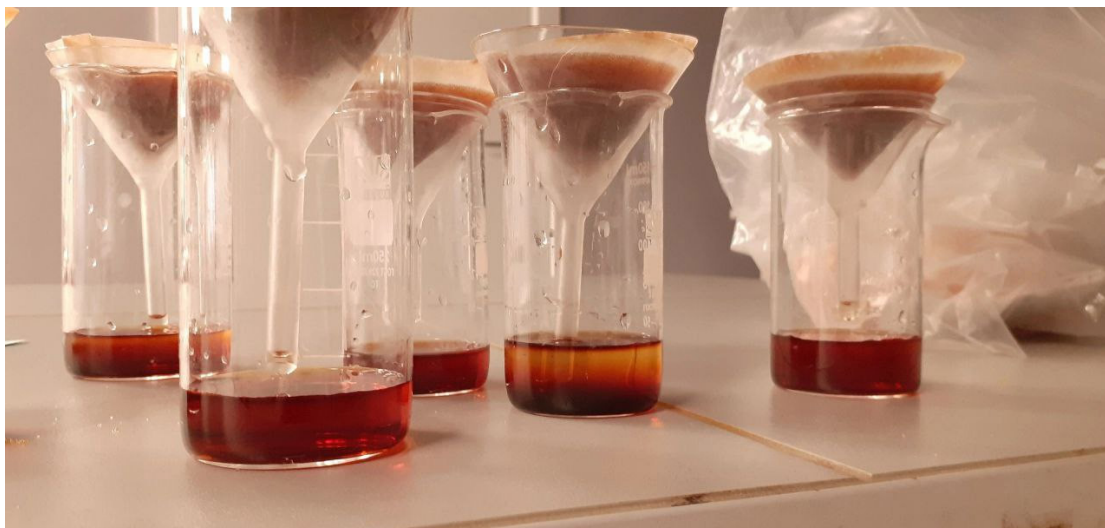
Рис. 1. Процесс пропускания \text{Na}_2\text{SiO}_3 через ионообменную смолу
