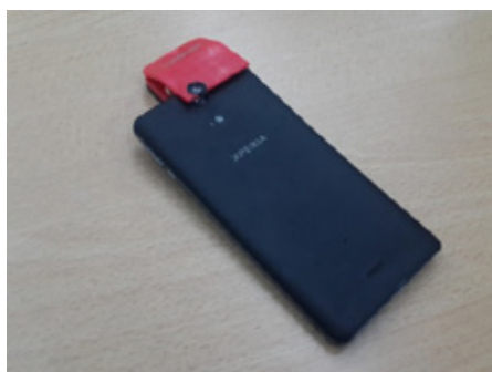
Рис. 2. Самодельная насадка-микроскоп для смартфона
