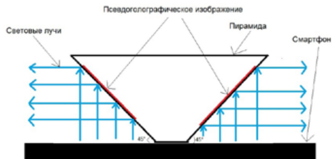
Рис. 2. Ход лучей в голографической пирамиде
