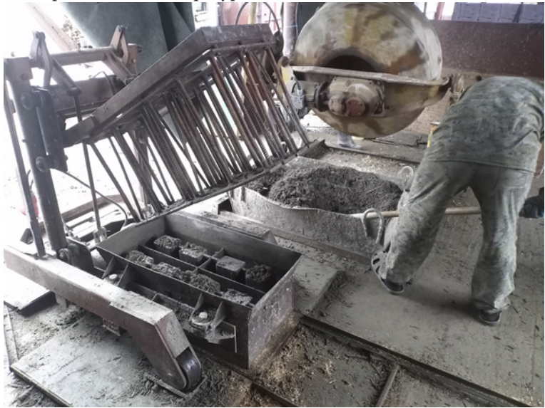
Рис. 6. Процесс закладки арболитовой смеси в вибростанок
