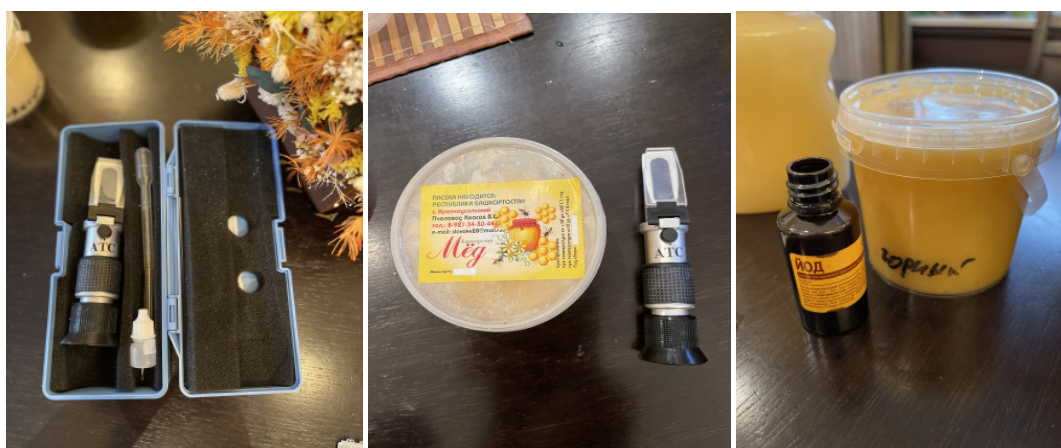
Рис. 1. Ручной рефрактометр МЕГЕОН и раствор 5% йода для анализа мёда
