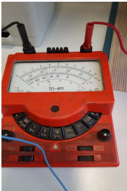
Рис. 2. Измерение напряжения при последовательном соединении цветков
