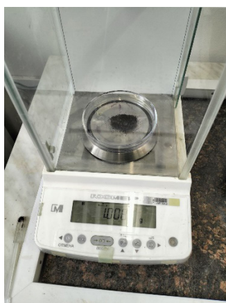
Рис. 3. Измерение влажности жмыха
