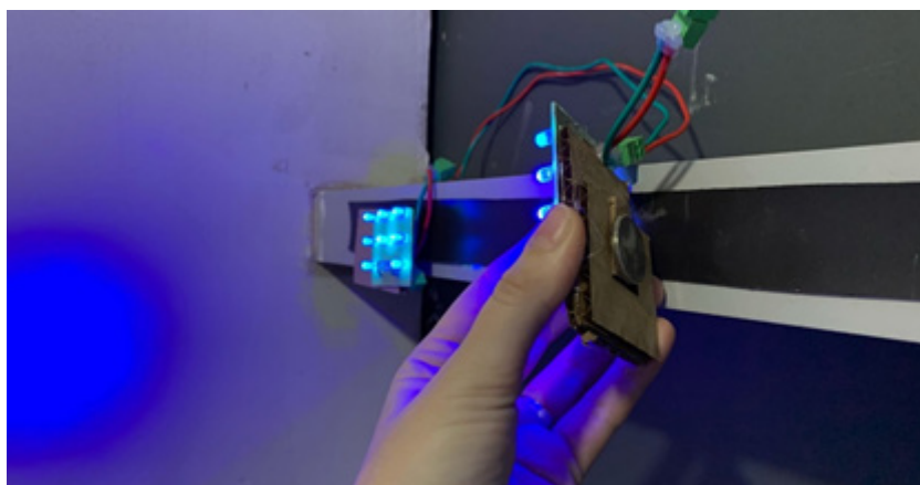
Рис. 4. Крепление ламп с помощью самоклеящейся магнитной ленты и неодимовых магнитов
