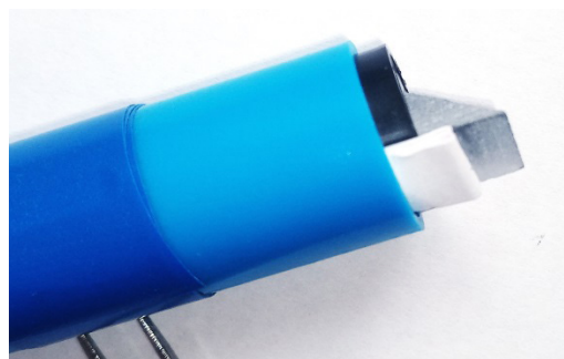
Рис. 3. Устранение промежутка между блоком призм и корпусом
