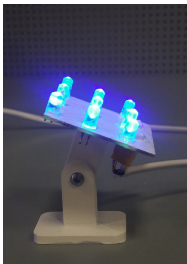
Рис. 6. Обновленное крепление модульной лампы из пластика
