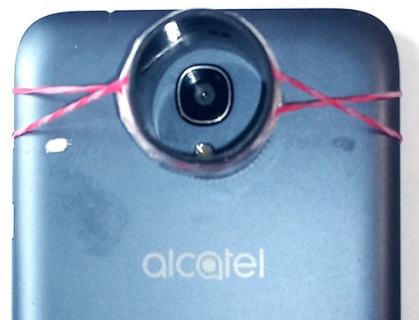
Рис. 7. Адаптер спектрометра для телефона.
