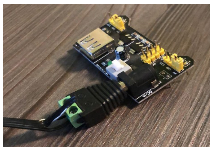
Рис. 2. Устройство-преобразователь для совмещения демо-модели Лего, Лего-мультиметра и реального прибора
