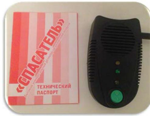
Рис. 2. Контрольный прибор — бытовой универсальный детектор загрязнителей воздуха «Спасатель»
