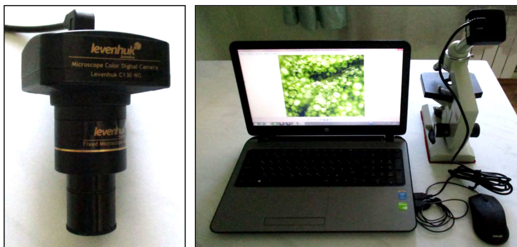
Рис. 6. Внешний вид цифровой видеокамеры Levenhuk и персонального компьютера в стадии получения и обработки микроскопического видеоматериала
