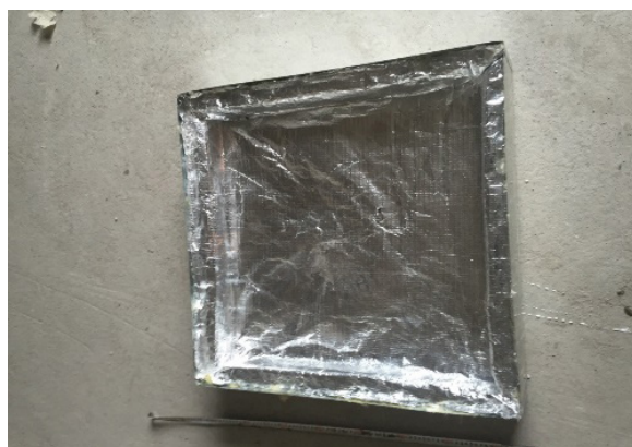
Рис. 5. Закрываем ее алюминиевой фольгой — это отражатель тепла
