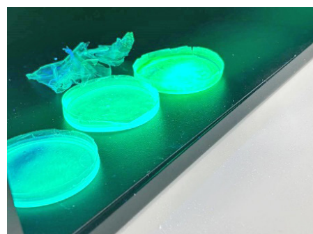
Рис. 4. Люминесценция композитной плёнки \text{CsPbBr}_3 /ПММА под воздействием УФ-излучения ( \lambda \approx 365 нм)
