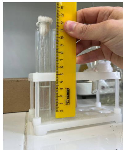
Рис. 2. Замер высота столба жидкости в пробирке над уровнем воды
