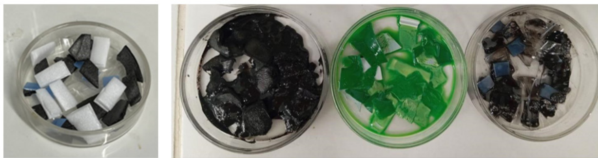
Рис. 3. Смесь фрагментов белого и черного вспененного полистирола, голубого полиэтилена и прозрачного полиэтилентерефталата
