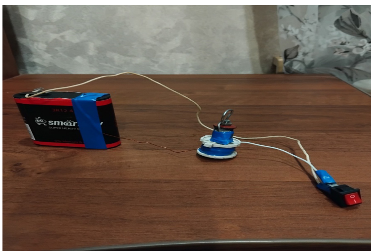
Рис. 2. Присоединение катушки с сердечником к батарейке
