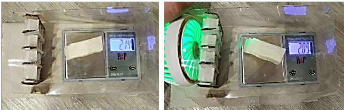
Рис. 3. Изменение веса выпукло-вогнутого крыла в воздушном потоке
