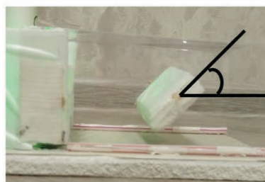
Рис. 1. Поведение модели крыла трапециевидальной формы при воздействии воздушного потока в аэродинамической трубе
