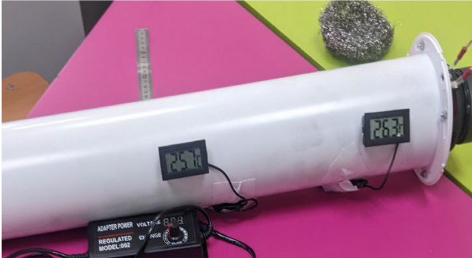
Рис. 3. Перепад температур, возникающий в результате работы модели акустического холодильника на протяжении 30 секунд
