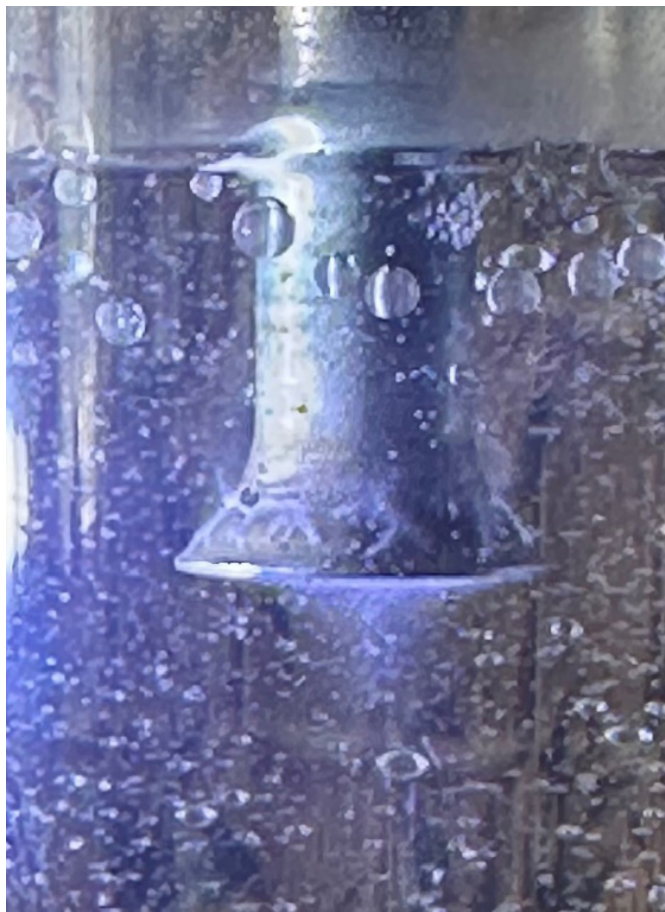
Рис. 2. Плотный конус («факел») из пузырьков, простирающийся в объем
