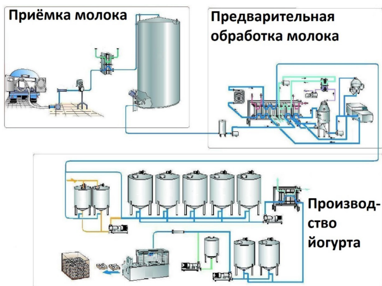
Рис. 2. Технологическая линия производства йогурта
