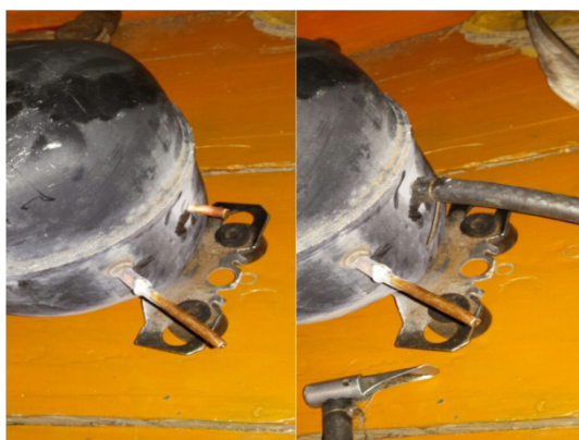
Рис. 3. В задней части компрессора вставляем шланг
