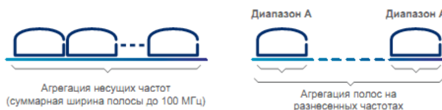
Рис. 2. Агрегация соседних несущих (слева) частот и агрегация полос на разнесенных частотах (справа)
