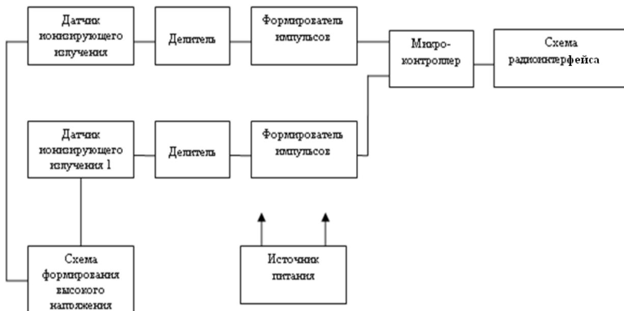
Рис. 2. Структурная схема устройства измерения
