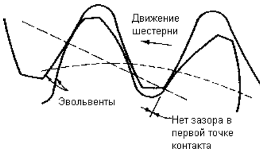
Рис. 1. Картина входа зуба в зацепление под нагрузкой без модификации
