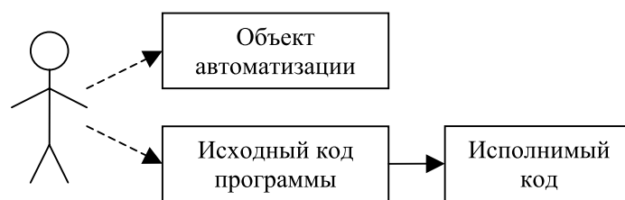
Рис. 1. Технология программирования до появления UML
