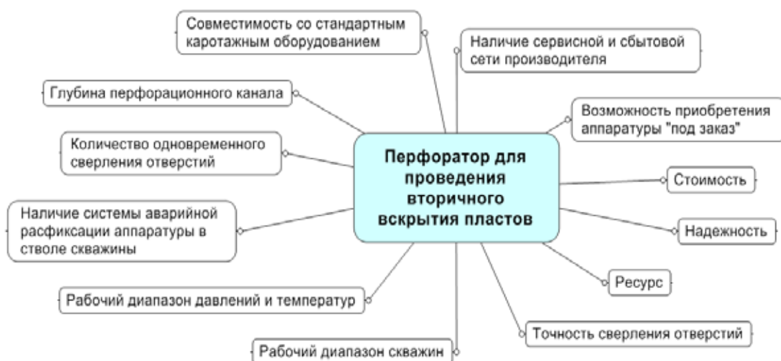
Рис. 2. Основные свойства аппаратуры для вторичного вскрытия пластов
