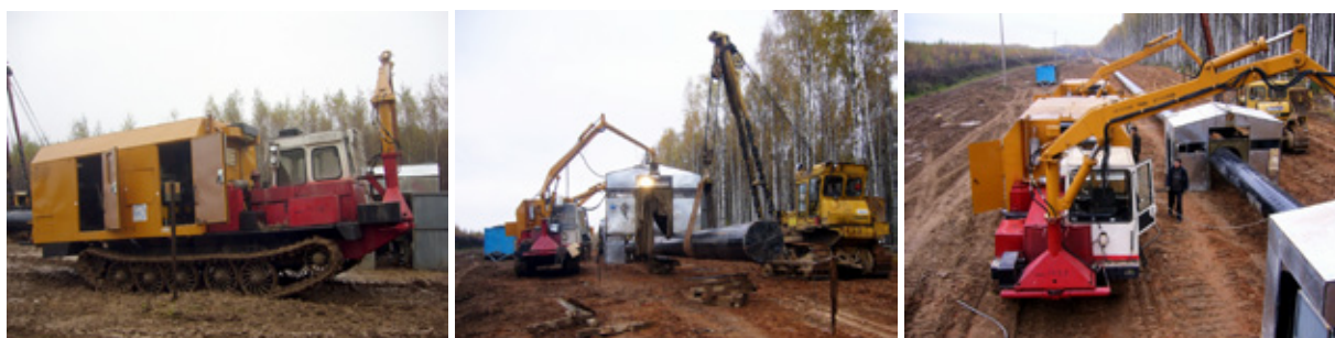
Рис. 1. Машина для сварки трубопроводов «АСТ-4-А»
