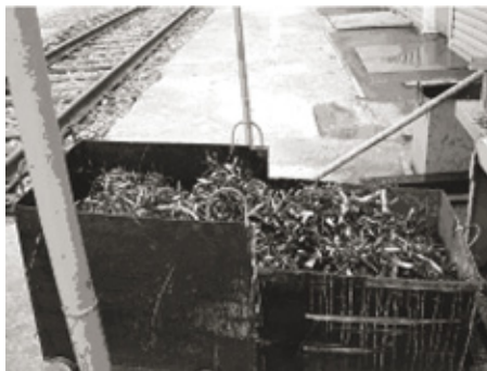
Рис. 5. Измельченная стружка в накопительном бункере
