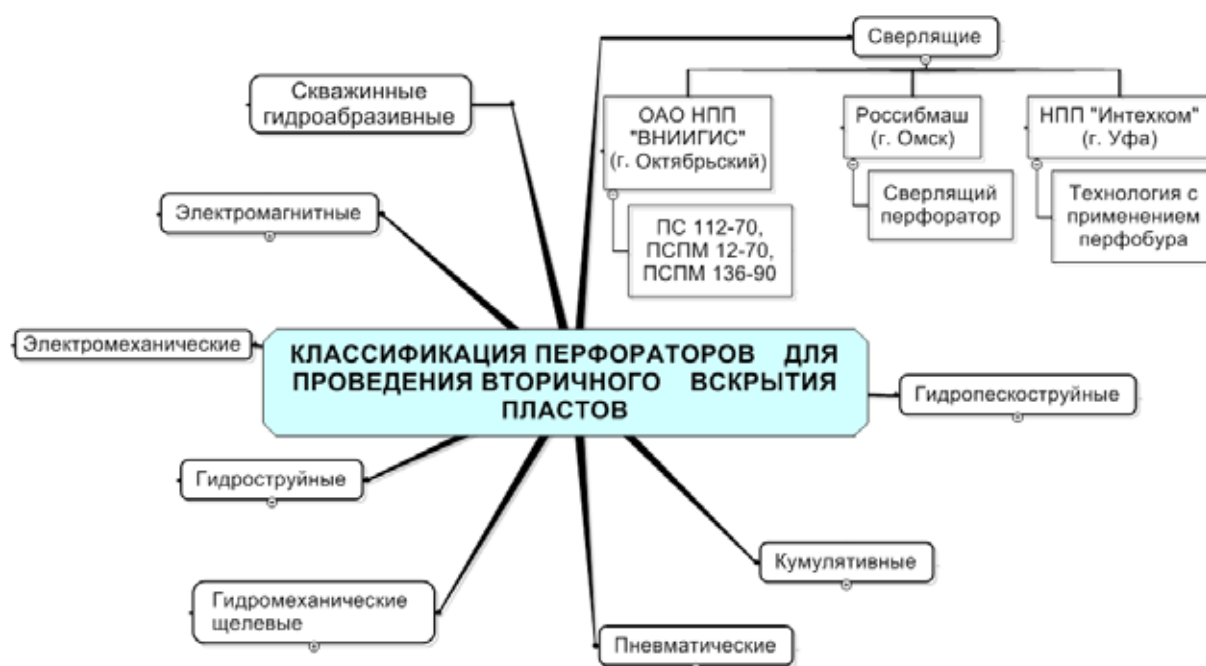
Рис. 1. Классификация перфораторов для проведения вторичного вскрытия пластов
