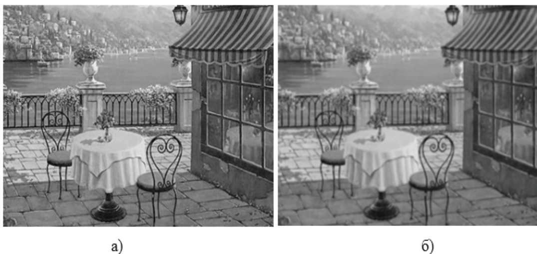
Рис. 1. Пример работы фильтра Гаусса: а) изображение в градациях серого; б) после применения фильтра с матрицей свёртки 3 \times 3
