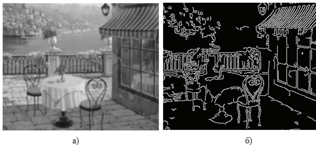
Рис. 3. Пример работы детектора Кенни: а)глаженное изображение (матрица 5 \times 5 ); б) границы, обнаруженные детектором Кенни
