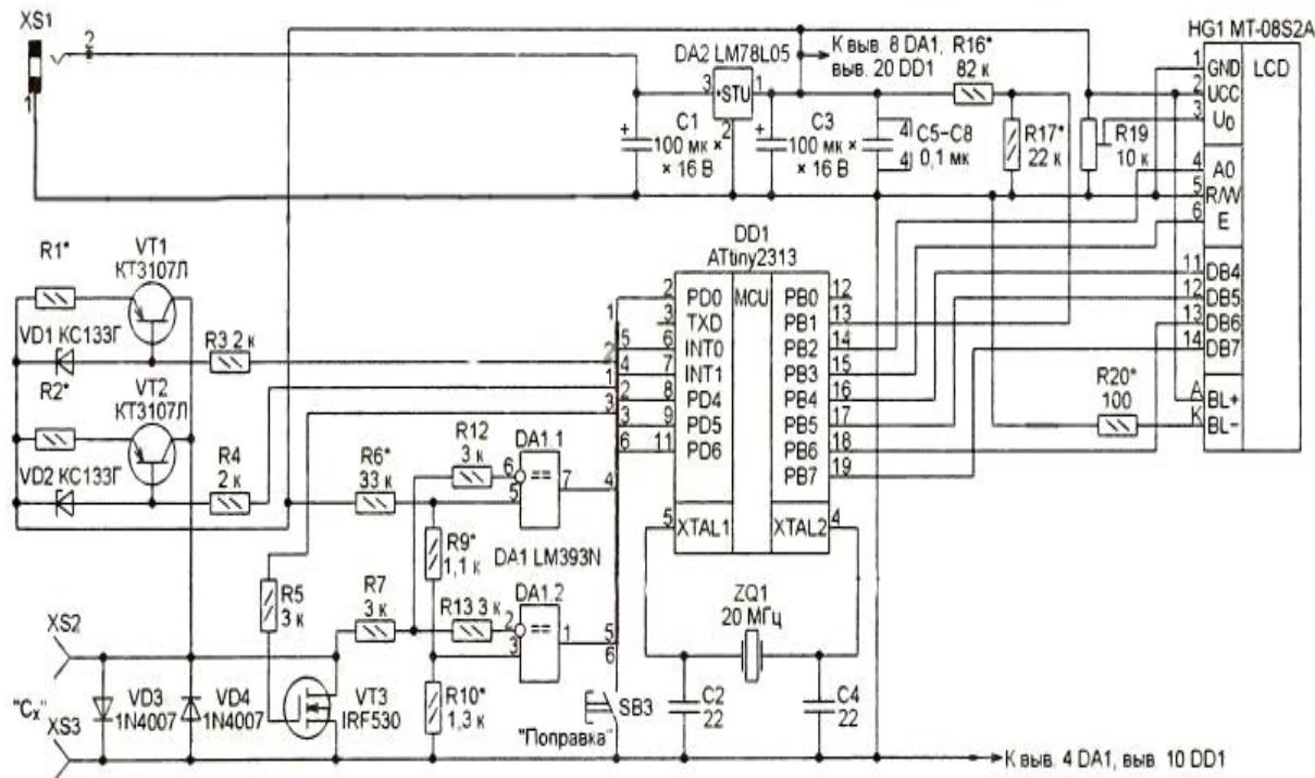
Рис. 3. Принципиальная электрическая схема измерителя ESR
