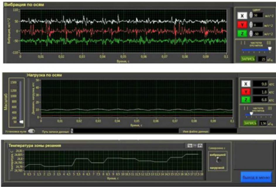
Рис. 7. Примеры регистрации вибрации, сил резания и температуры на динамометре STD 201–2
