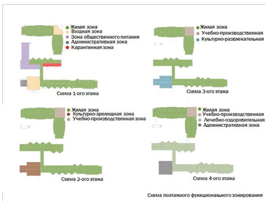
Рис. 5. Схема поэтажного функционального зонирования
