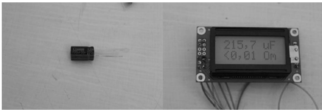
Рис. 6. Измерение конденсатора 220 мкф
