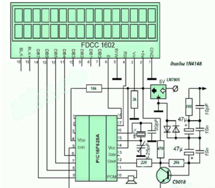
Рис. 1. Принципиальная электрическая схема частотомера
