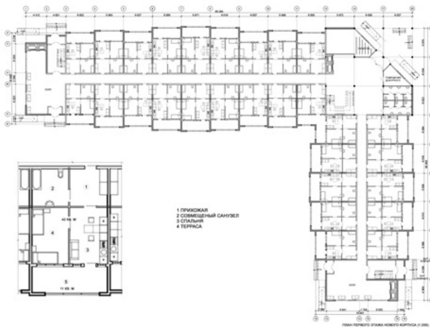
Рис. 7. План первого этажа нового корпуса
