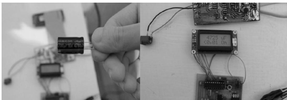
Рис. 5 Измерение конденсатора 4700 мкФ
