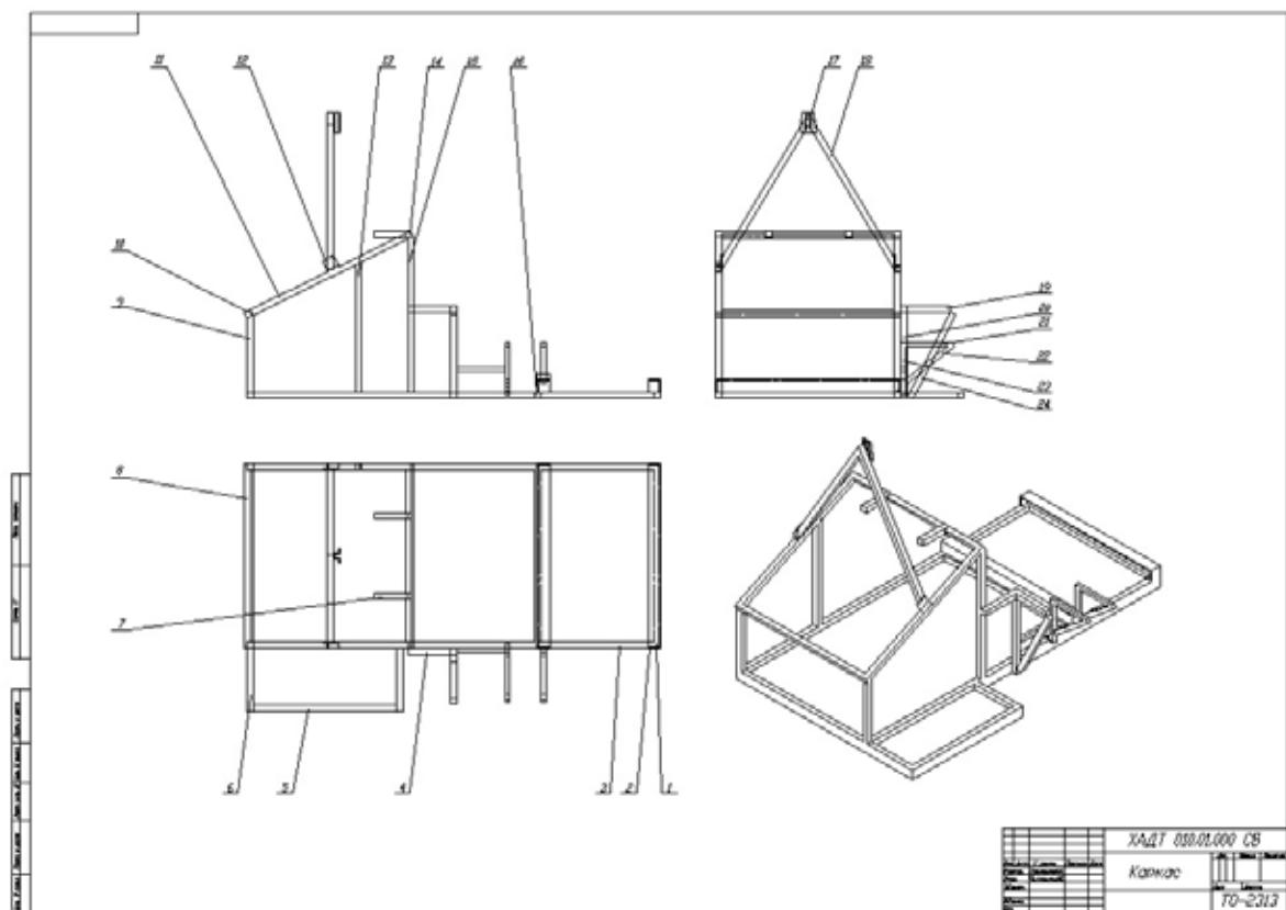
Рис. 2. Сборочный чертёж каркаса
