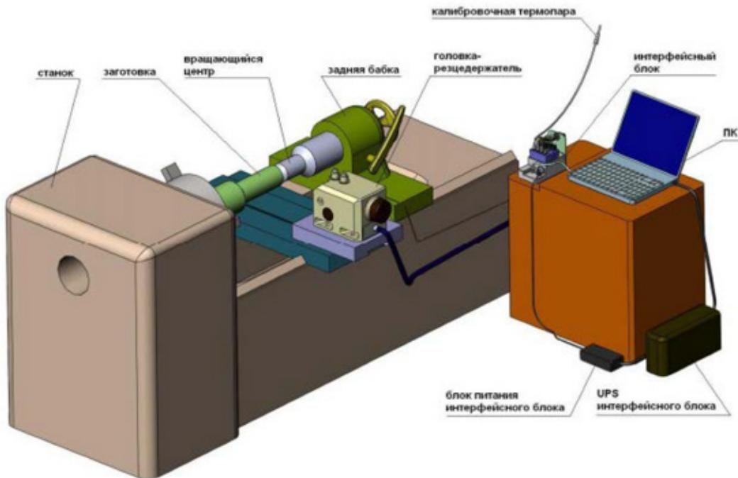
Рис. 2. Схема расположения лабораторно-исследовательского комплекса
