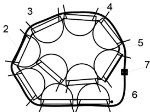
Рис. 2. Гибкое бетонное защитное покрытие, свернутое в рулон
