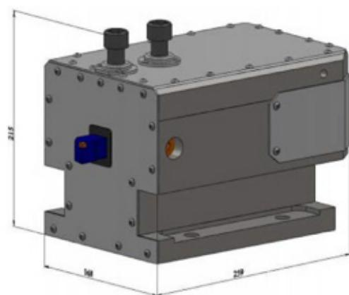
Рис. 4. Внешний вид головки резцодержателя
