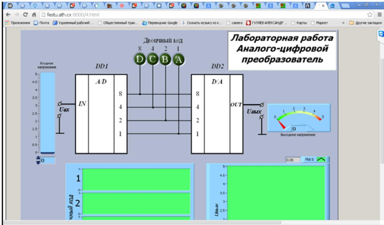
Рис. 4. Лабораторная работа АЦП на странице Web браузера
