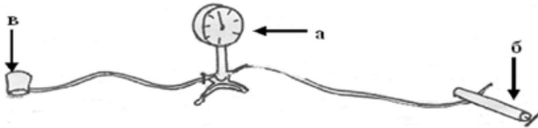
**Рис. 2. Прибор для оценки С-витаминной адекватности питания путем определения резистентности капилляров кожи (резистометр)**
