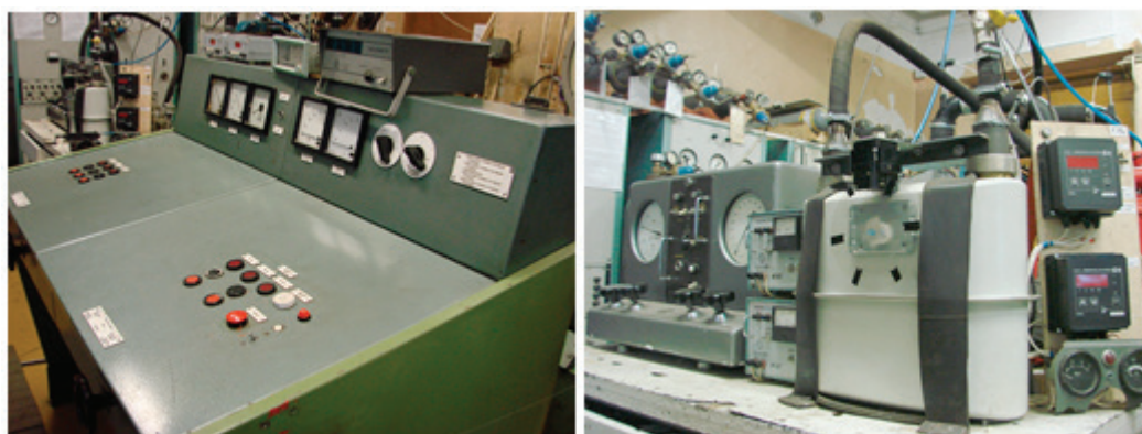
Рис. 1. Общий вид тормозного стенда САК-N670 и применяемого оборудования
