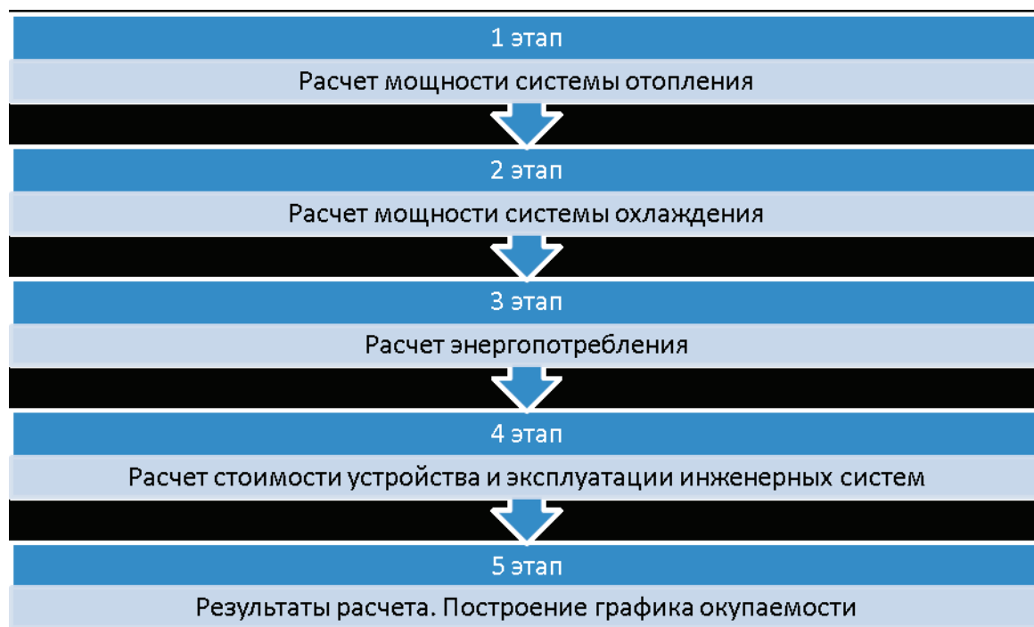
Рис. 1. Алгоритм расчета затрат на устройство инженерных систем
