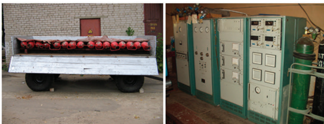
Рис. 2. Общий вид передвижной заправочной станции для КПП и системы газового анализа АСГА-Т
