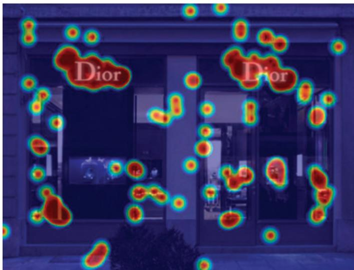
Рис. 4. Ложные срабатывания метода SIFT на базе из 100 логотипов
