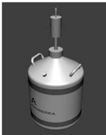
Рис. 1. 3D геометрическая модель HrGe детектора с образцом
