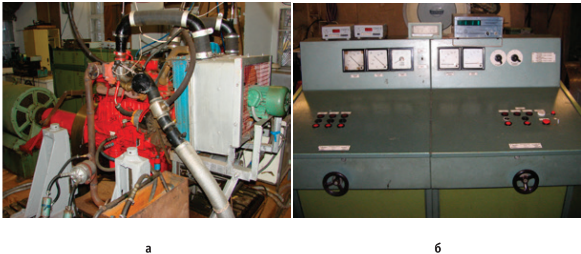
Рис. 1. Общий вид экспериментальной установки (а) и пульт управления электротормозным стендом (б)
