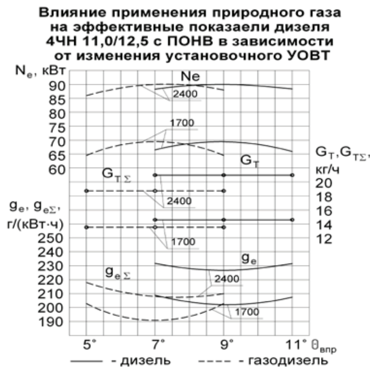
Рис. 2. Влияние применения КПГ на эффективные показатели дизеля 4ЧН 11,0/12,5 с ПОНВ в зависимости от изменения установочного УОВТ при n = 2400 \text{ мин}^{-1} , p_e = 0,947 \text{ МПа} , и n = 1700 \text{ мин}^{-1} , p_e = 1,036 \text{ МПа} : — — дизельный процесс, - - - газодизельный процесс
