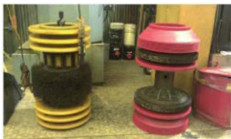
Рис. 1. Скребок Vi-Di с кистевыми щетками
