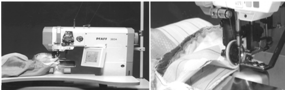
Рис. 2. Машина фирмы «Pfaff» для втачивания рукава в пройму изделия
