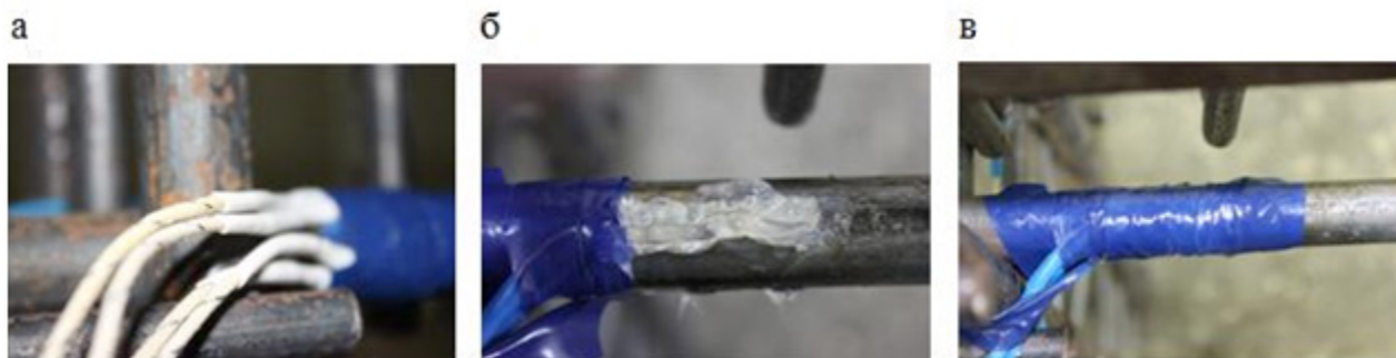
Рис. 3. Последовательность гидроизоляции тензорезисторов: а — вид проводов, обжатых термоусадочной трубкой; б — вид датчика, обработанного силиконовым герметиком; в — вид датчика, защищённого изоляционной лентой
