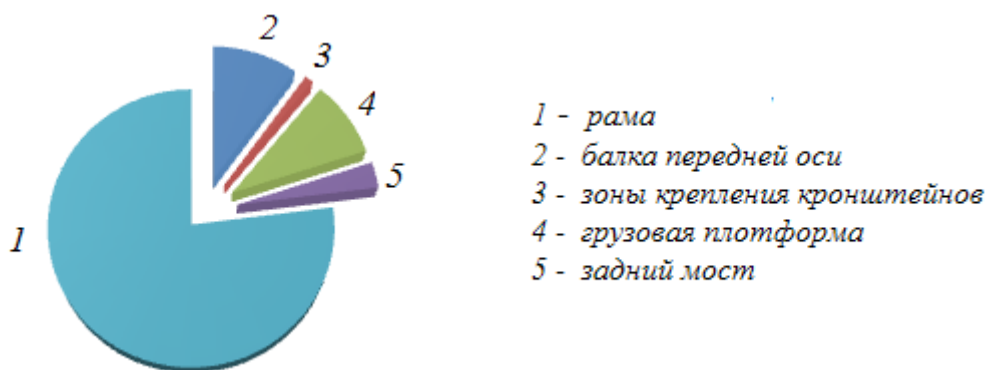
Рис. 3. Распределение зон трещинообразования, полученное на основании анализа данных технического диагностирования
