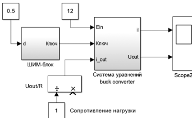
Рис. 7. Блок-схема понижающего преобразователя с идеальным ключом
