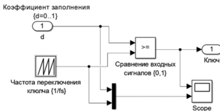
Рис. 6. ШИМ-блок понижающего преобразователя
