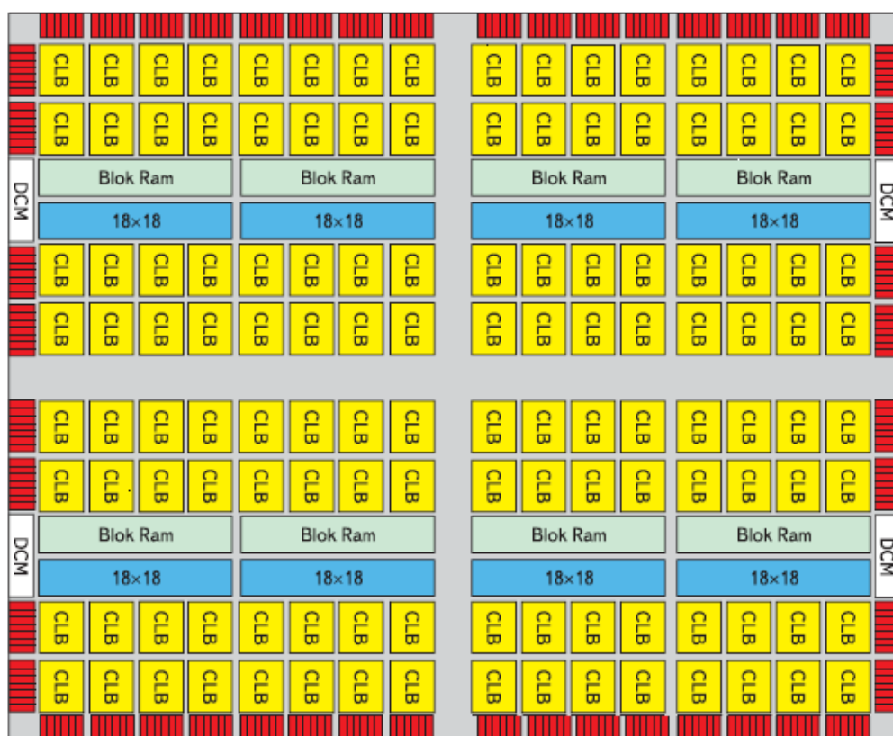
Рис. 1. Структурная организация кристалла ПЛИС семейства SPARTAN-3E
