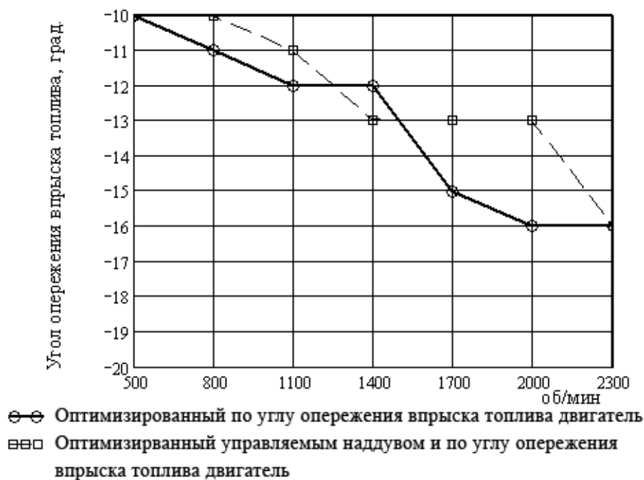
Рис. 22. Изменение оптимального значения угла опережения впрыска топлива на обоих этапах оптимизации по этому параметру в зависимости от режима (частоты вращения коленвала).
