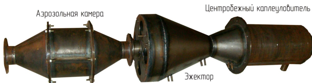
Рис. 2. – Жидкостной нейтрализатор отработавших газов дизеля
