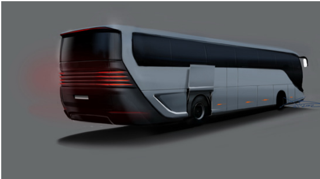
Рис. 3. Экстерьер автобуса с обтекателем заднего колесного движителя. Открытое положение
