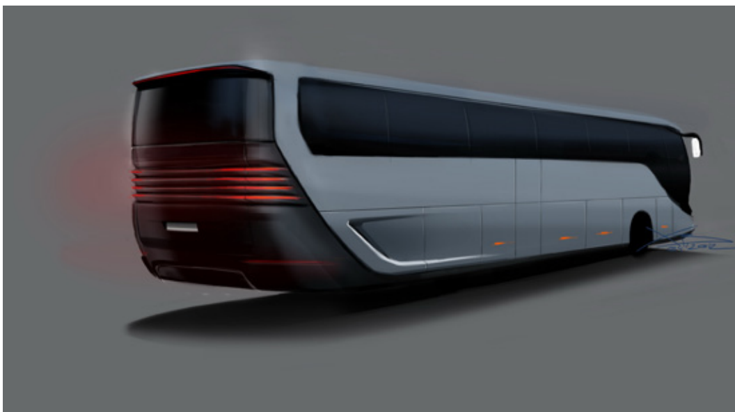
Рис. 2. Экстерьер автобуса с обтекателем заднего колесного движителя. Закрытое положение
