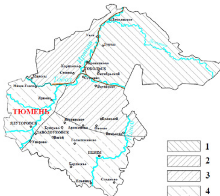
Рис. 3. Районы, выделенные по степени сложности природных условий Тюменской области для строительства дорог (по Т. В. Звонковой, Н. В. Филанчук): 1 — очень сложные; 2 — сложные; 3 — осложненные; 4 — относительно простые
