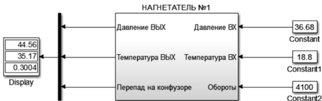
Рис. 6. Simulink-модель нагнетателя ГПА (блок «Subsystem») и результаты симуляции
