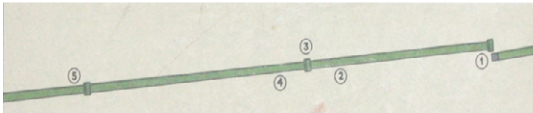
Рис. 2. Порядок расстановки номеров при монтаже трубопровода
