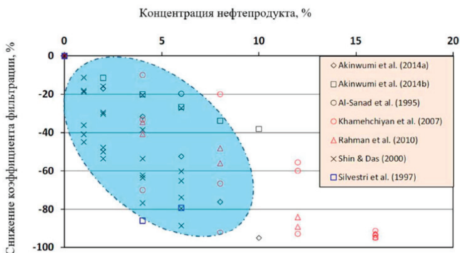
Рис. 1. Зависимость от увеличения количества нефтепродуктов к коэффициенту фильтрации песчаных грунтов [2]
