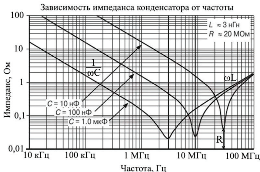
Рис. 4. Импеданс конденсаторов различной емкости при одинаковом размере корпуса
