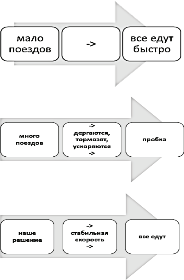
Рис. 1. Иллюстрация эффекта логистической инерции: при высокой загрузке попытки ускорения отдельных поездов приводят к глобальному замедлению системы
