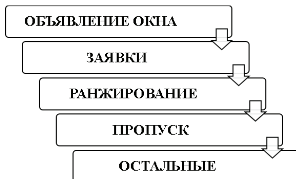
Рис. 7. Алгоритм распределения пропускной способности на основе декларируемой толерантности к ожиданию
