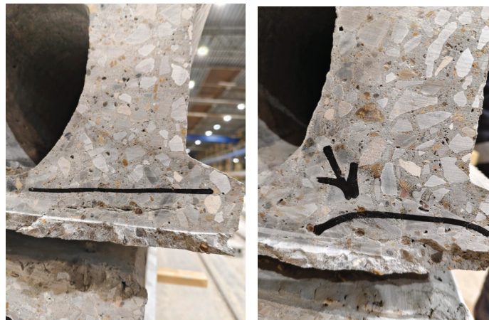
Рис. 1. Непроформовка «юбки» плиты перекрытия
