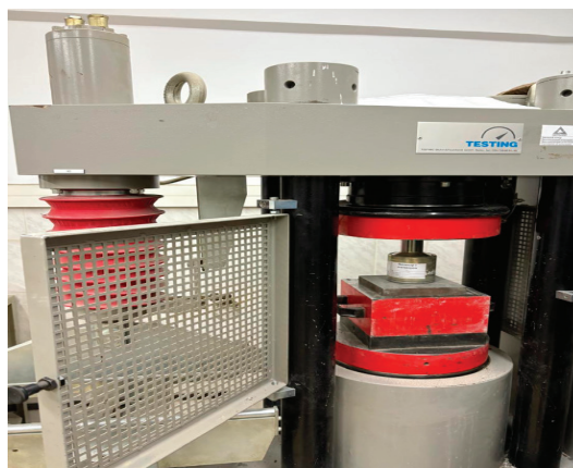
Рис. 9. Определение марки гранул при дроблении
