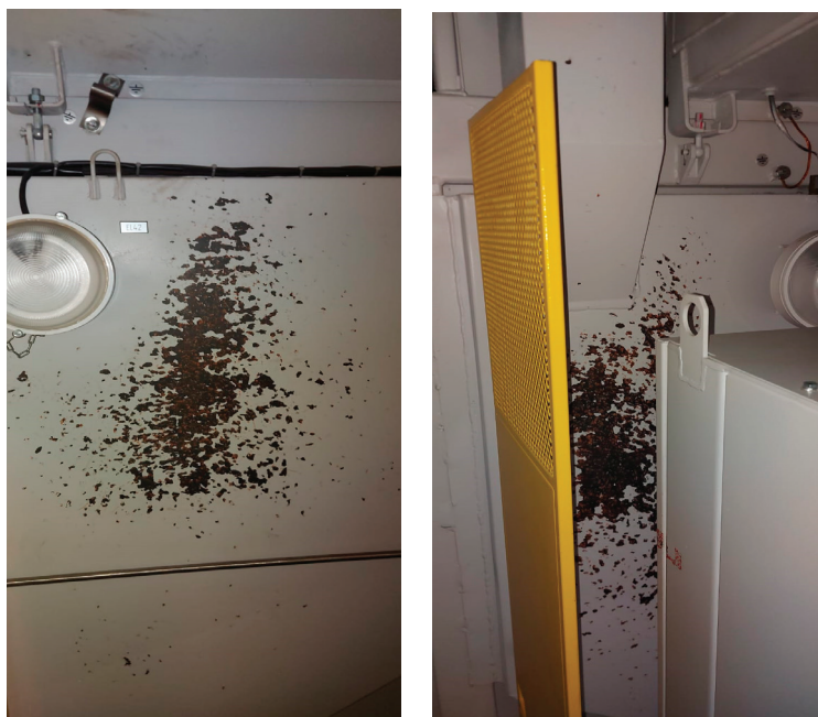
Рис. 1. Примеры повреждения лакокрасочного покрытия песочного бункера
