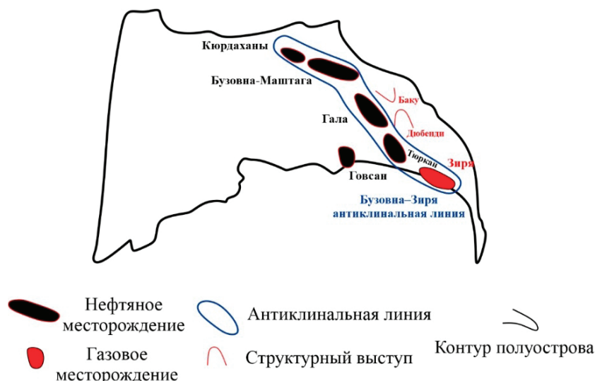
Рис. 1. Схема размещения месторождений, структурных выступов и антиклинальных поднятий в восточной части Апшеронского полуострова
