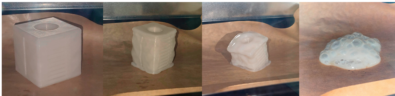
Рис. 3. Ход испытания PETG
