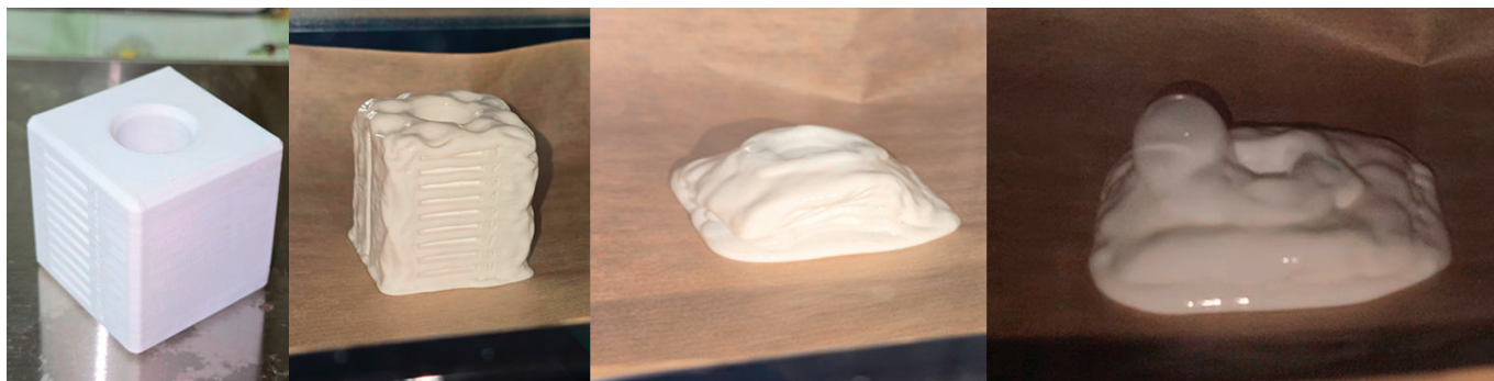
Рис. 2. Ход испытания PLA
