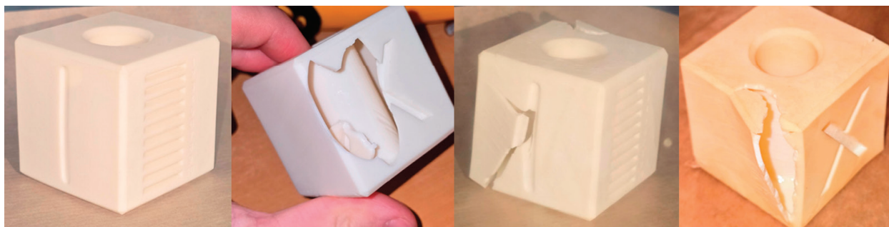
Рис. 5. Ход испытания фотополимерной смолы
