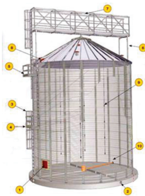
Рис. 1. Зернохранилище компании Silesfor: 1 — Боковая дверь; 2 — Вентиляционный люк; 3 — Лестница обслуживания; 4 — Смотровая площадка; 5 — Смотровая площадка; 6 — Стойки надсилосной галереи; 7 — Надсилосная галерея; 8 — Смотровой люк; 9 — Термодатчики; 10 — Зачистной шнек [5]
