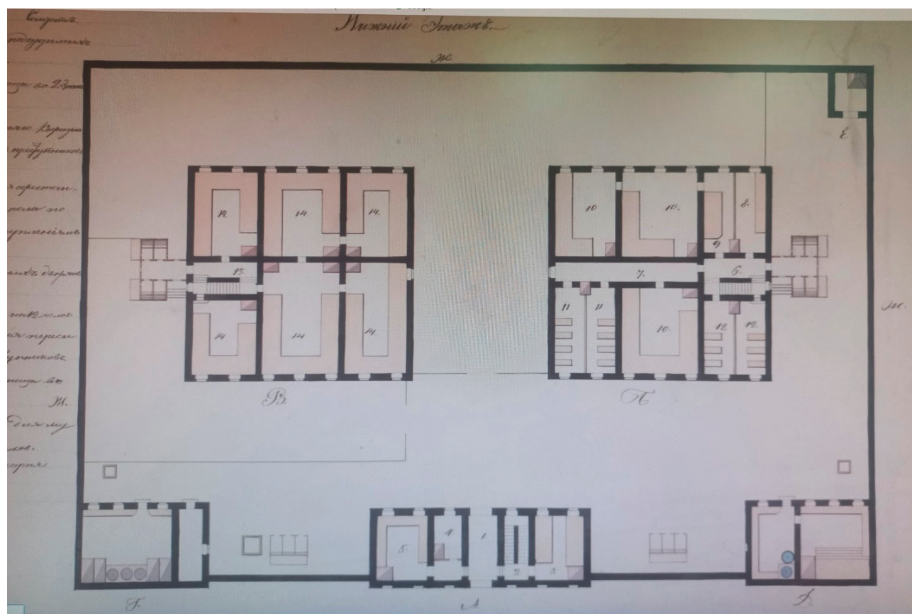
Рис. 8. Проектный чертеж Тюремного замка, август 1827 г. План нижнего этажа. Автор — В. Невин. Подписан членом строительного комитета Давидом Висконти. «А» — смотрительский дом, «Б» — корпус для подсудимых арестантов, «В» — корпус для пересылочных арестантов, «Г» — кухня и пекарня, «Д» — баня, «Е» — кузница, «Ж» — ограда [10, л. 8]
