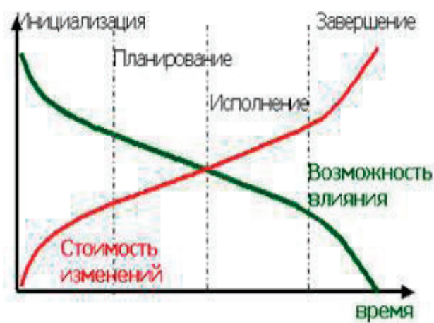
Рис. 2. Зависимость способности влиять на результат и стоимости изменений в проекте от этапов его ЖЦ
