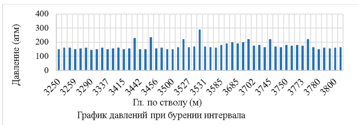
Рис. 22. Статистические данные зависимости давления на линии манифольда от углубления забоя (при строительстве эксплуатационной колонны на полимерхлоркалийевой системе)
