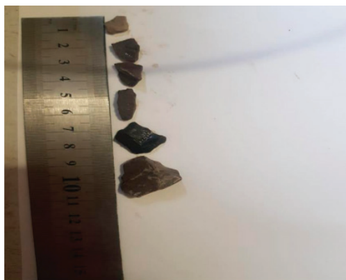
Рис. 17. Шлам, отобранный при бурении в интервале 3827–3830 м
