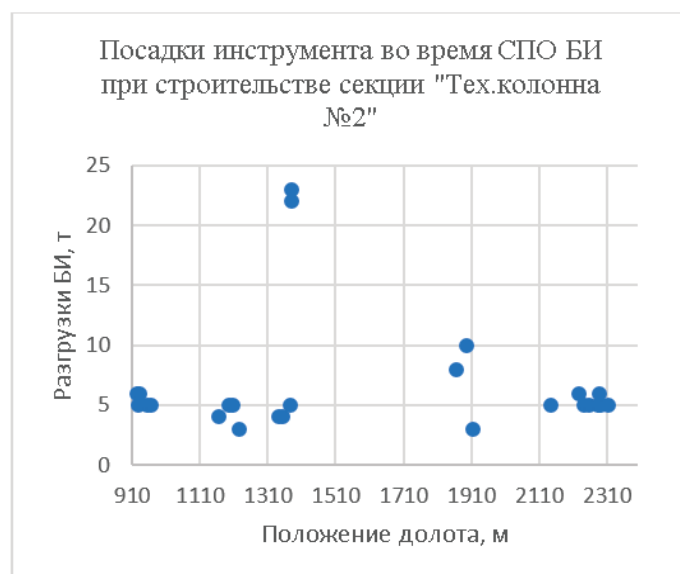
Рис. 9. Диаграмма глубин посадок бурового инструмента при СПО
