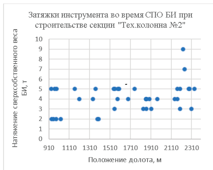
Рис. 8. Диаграмма глубин затяжек бурового инструмента при СПО
