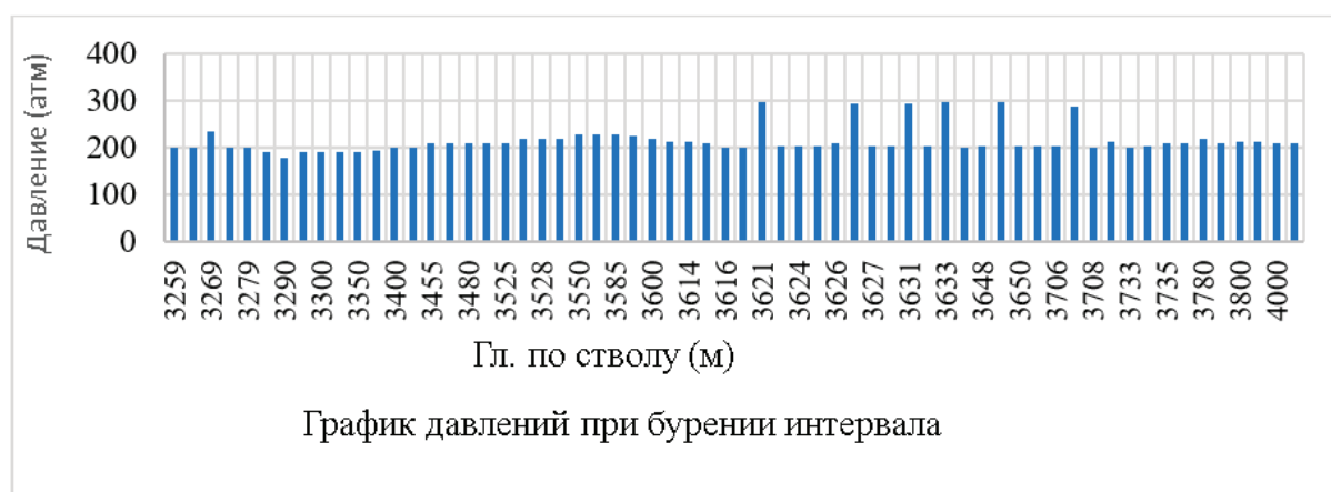
Рис. 24. Статистические данные зависимости давления на линии манифольда от углубления забоя (при строительстве эксплуатационной колонны на системе РУ0)
