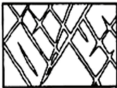
Рис. 14. Трещиноватая структура осадочных обезвоженных пород
