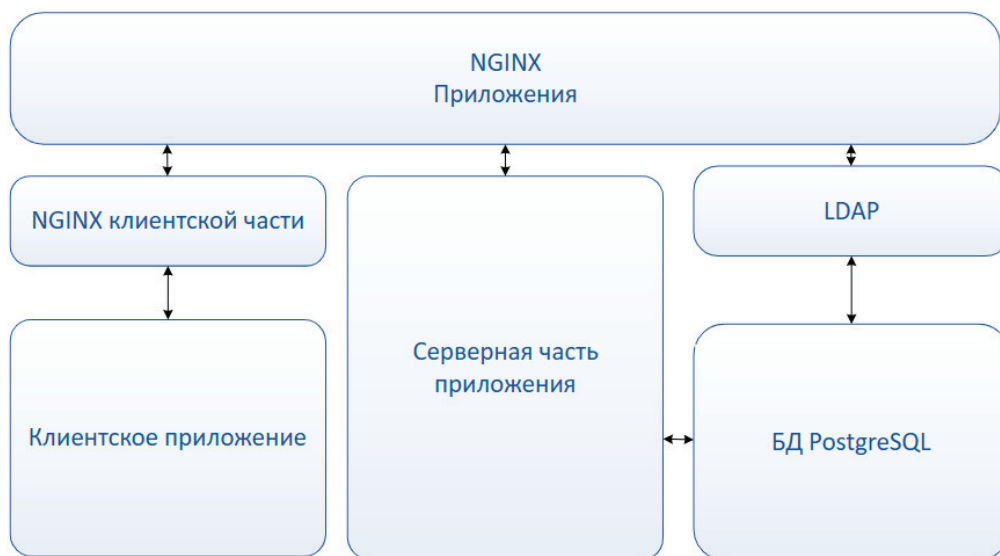
Рис. 1. Структурная схема сервиса автоматизированного тестирования лабораторных работ
