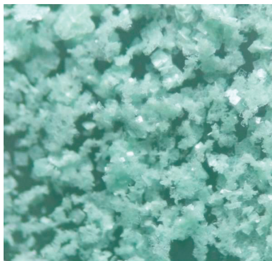
Рис. 2. Микрофотография (\text{NH}_4)_4[\text{NiMo}_6\text{O}_{18}(\text{OH})_6] \cdot 5\text{H}_2\text{O}
