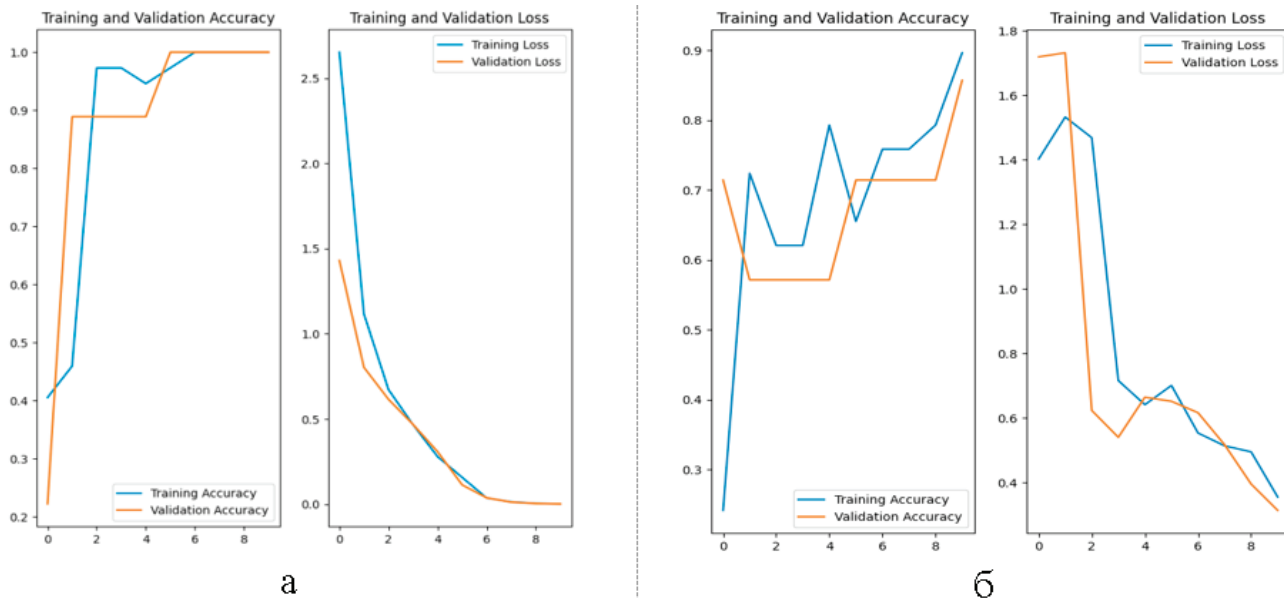
Рис. 1. Графики точности и потерь для тренировочного и проверочного исходного набора данных (а) и увеличенного набора данных с повторным обучением (б)
